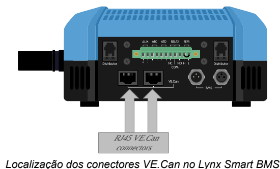
Localização dos conectores VE.Can no Lynx Smart BMS
